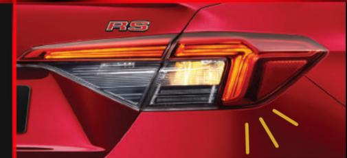
Đèn báo phanh khẩn cấp tự động kích hoạt khi xe dừng đột ngột, giúp hạn chế va chạm với các xe phía sau.
